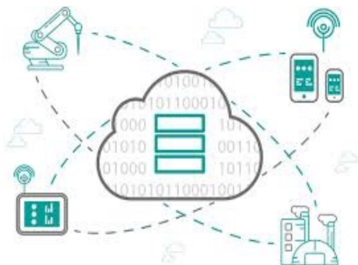
FIG. 01 – PILARES 4.0 – a geração contínua de dados de equipamentos interligados entre si, através de uma rede e que são armazenadas em nuvem para um processo contínuo e analítico de informações, que avaliam sua condição de operação e fazem ajustes automaticamente, para garantir a entrega dos parâmetros definidos inicialmente para o produto ou serviço demandado pelo Cliente.
